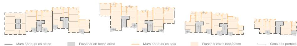
Murs porteurs en béton, Plancher en béton armé, Murs porteurs en bois, Plancher mixte bois/béton, Sens des portées
