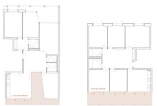
Le balcon et les courasses comme obstacles à la propagation du bruit à l'air au bruit vis-à-vis de l'extérieur.
